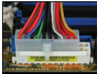
20-pin power connector (Konektor daya 20-pin) (pada 24-pin female counterpart (penompang dalam 24-pin))
