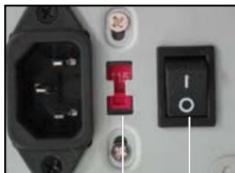
Hálózati feszültségbemenet választókapcsolója Üzemkapcsoló „-”: Be, „O”: Ki
