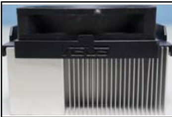
Tampilan samping pada heatsink (penurun panas) dan fan (kipas angin)
