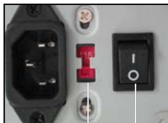
สวิตช์แรงดันไฟฟ้า AC ขาเข้า
