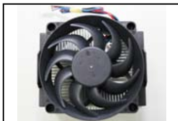
Vedere de sus a radiatorului și a ventilatorului
