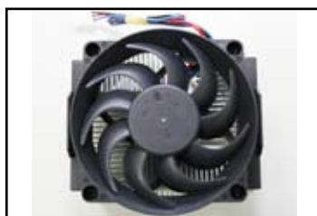
Радиатор и вентилятор, вид сверху
