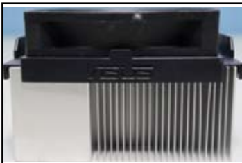
มุมมองด้านข้างของครีบบรรเทาความร้อนและพัดลม
