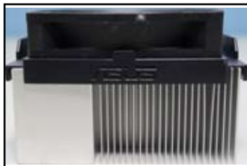
Vista laterale del dissipatore di calore e della ventola
