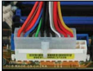
20 érintkezős tápcsatlakozó (a 24 érintkezős hüvelyen)
