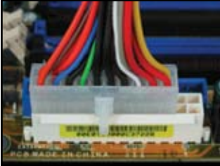
طرف توصيل طاقة ذو ٢٠ دبوسا (يتم تركيبه على المقبس الأنثى ذو ٢٤ دبوسا)
