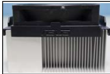
Boční pohled na tepelnou jímku a ventilátor
