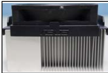
Vedere laterală a radiatorului și a ventilatorului
