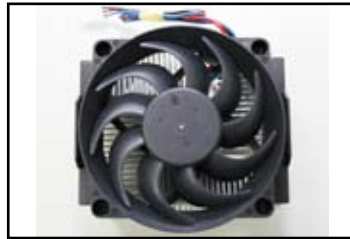
Isı emici ve fan üst görünümü
