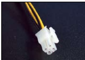
4 érintkezős ATX csatlakozó
