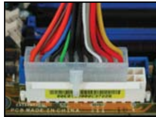
Conector de alimentación de 20 pins (en su correspondiente conector hembra de 24 pins)
