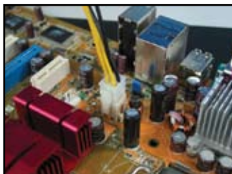
4kolíkový konektor napájení
