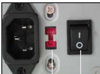
Превключвател за входното напрежение
