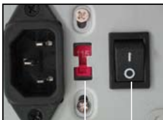
Comutador para ajuste da entrada de voltagem a.c.
