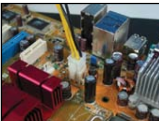
Conector de alimentación de 4 pins
