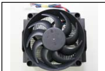
Поглед към радиатора и вентилатора отгоре
