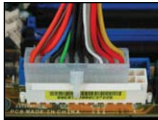
20-pin power connector (Konektor daya 20-pin) (pada 24-pin female counterpart (penopang dalam 24-pin))
