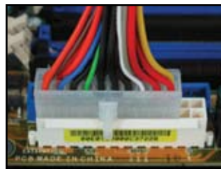
Konektori za struju od 20-čioda (na „ženskom“ duplikatu sa 24-čiode)
