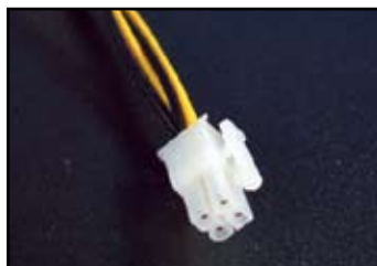
ATX konektori za struju od 4-čioda
