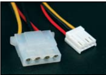
หัวต่อเพาเวอร์อุปกรณ์ต่อพ่วง (ซ้าย) หัวต่อเพาเวอร์ฟล็อปปี้ (ขวา)
