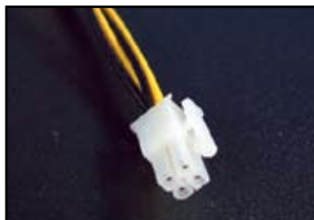
Conector de alimentação ATX de 4 pinos
