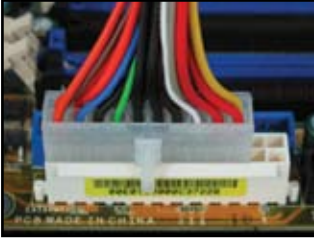
طرف توصيل طاقة ذو ٢٠ دبوسا (يتم تركيبه على المقبس الأنثى ذو ٢٤ دبوسا)
