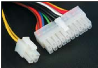
Conector de alimentação ATX de 20+4 (24) pinos
