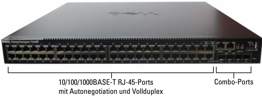
Abbildung 1-6. PowerConnect 7048R mit 48 10/100/1000BASE-T-Ports
