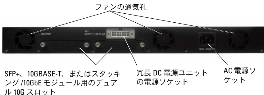
図 1-8. PC7024/PC7024F/PC7048 の背面パネル
