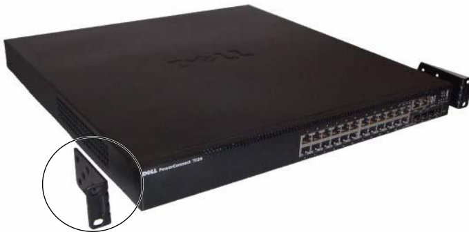
Ilustración 1-11. Fijación de los soportes
