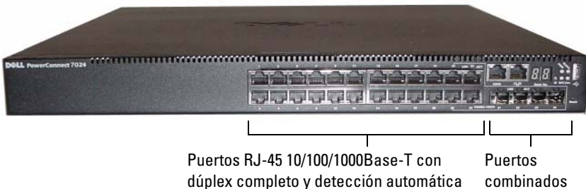
Ilustración 1-1. PowerConnect 7024 con 24 puertos 10/100/1000Base-T
