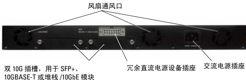
图 1-9. PC7024P 和 PC7048P 背面板
