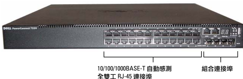
圖 1-1. PowerConnect 7024，具有 24 個 10/100/1000BASE-T 連接埠
