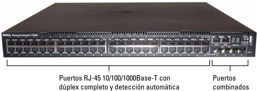
Ilustración 1-4. PowerConnect 7048 con 48 puertos 10/100/1000Base-T
