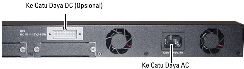
Gambar 1-15. Hubungan Daya AC dan DC ke Switch
