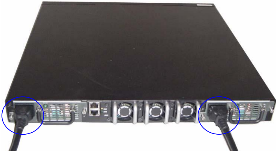
Gambar 2. Menghubungkan Kabel Daya
