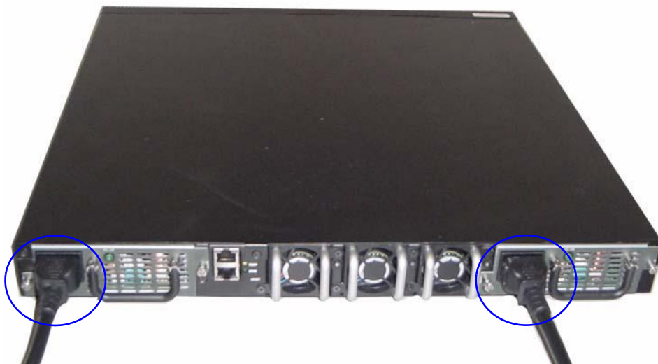
図 2 電源ケーブルの接続
