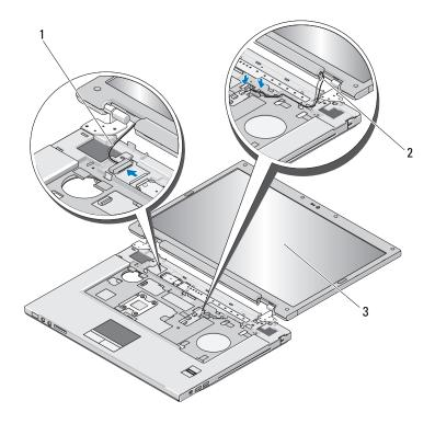
1 display cable 2 antenna cables
