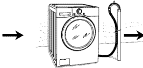
Conexión del tubo de desagüe
