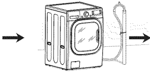
Conexión del tubo de desagüe
