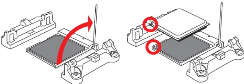
3. Ist die APU korrekt installiert, sollten die Pins an der Unterseite vollständig versenkt und nicht mehr sichtbar sein. Beachten Sie bitte, dass jede Abweichung von der richtigen Vorgehensweise beim Einbau Ihr Motherboard dauerhaft beschädigen kann.
