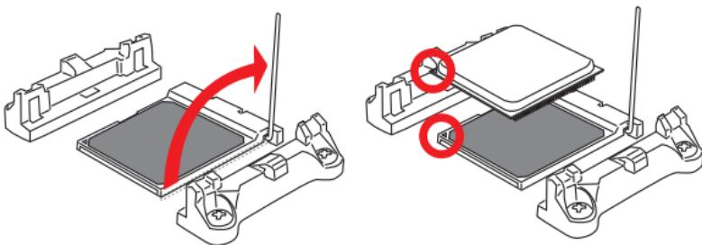
3. 如果APU安装正确，针脚应该完全插入底座而不能被看见。请注意任何违反正确操作的行为都可能导致主板的永久性损坏。
