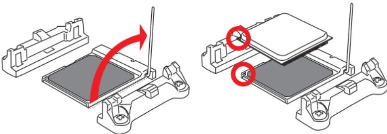
3. При правильной установке APU его контакты полностью войдут в разъем, и их не будет видно. Помните, что любые применение силы при установке APU может вызвать серьезные повреждения системной платы.
