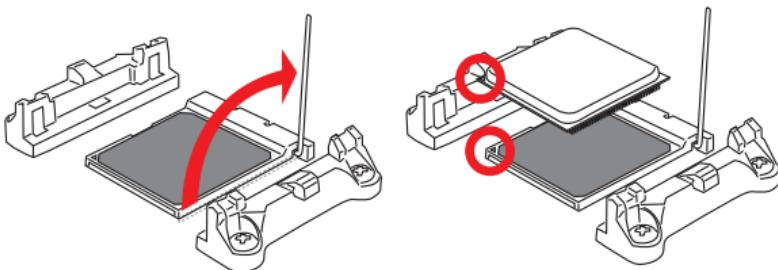
3. APUが正しく装着された状態では、ピンがソケットにぴったりと差し込まれています。横から見てピンが浮いているような状態であれば、向きを確認して取り付けをやり直してください。間違ったAPUの装着はAPUやマザーボードに重大な損傷を与えてしまいますので、くれぐれもご注意ください。
