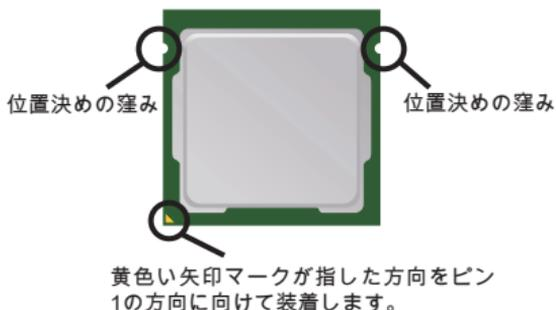
下記の手順に従って正しくCPUとCPUクーラーを装着してください。
