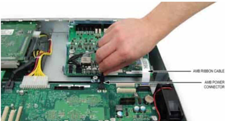
Figure 32: Disconnecting the AMB Power Connector
