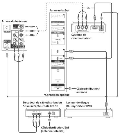
\* La connexion optique est requise seulement lorsque le système de cinéma-maison n'est pas compatible ARC (Audio Return Channel) et qu'il est connecté en HDMI. Définissez les réglages d'enceinte sur sortie audio, appuyez sur **HOME**, puis sélectionnez [Paramètres] → [Son] → [Haut-parleurs] → [Système audio]. Définissez les réglages HDMI CEC sur le téléviseur et sur le récepteur audio-vidéo pour autoriser la commande audio du système et les connexions ARC.
