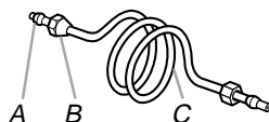
A. Manguito de compresión B. Tuerca de compresión C. Tubería de cobre
